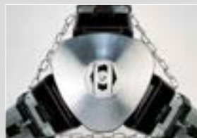
Een rondomlopende staaketting verhindert op gladde bodem het wegschuiven van de statiefpoten.
